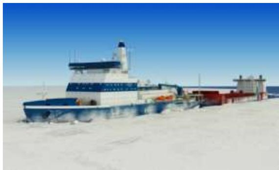
**Универсальный атомный ледокол проекта 22220**, пропульсивной мощностью 60 МВт
