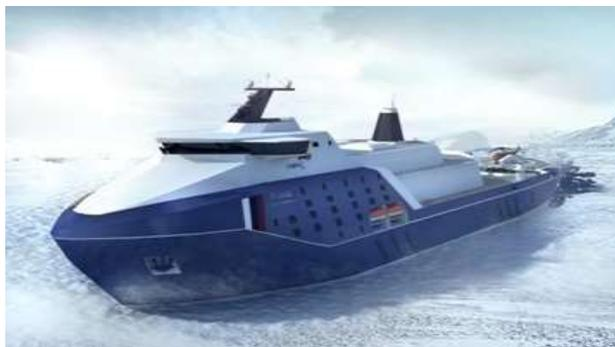
**Атомный турбоэлектрический ледокол проекта 10510**, пропульсивной мощностью 120 МВт
