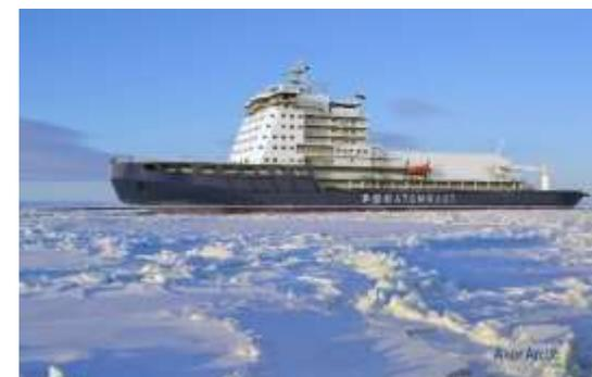
**Линейный ледокол проекта Aker ARC 123**, пропульсивной мощностью 40 МВт
